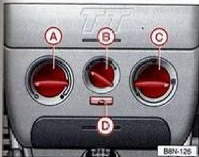
**Éléments de commande****A – Commande de température**
