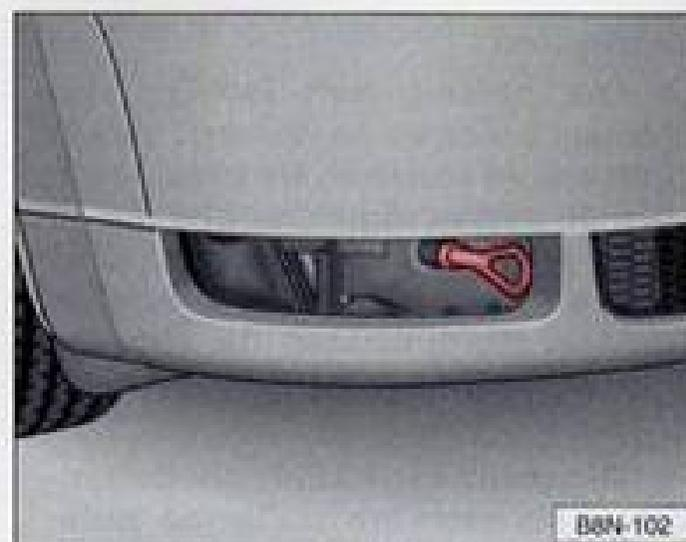
Vissez solidement l'œillet de remorquage dans le filetage jusqu'en butée.
