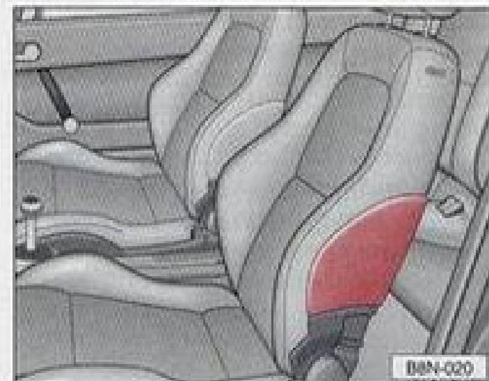
**Les airbags latéraux** sont logés dans les rembourrages des dossiers de sièges avant (voir figure). Les emplacements de montage sont repérés par le monogramme « AIRBAG ».
