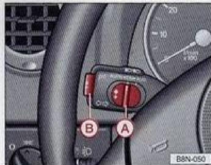
Le dispositif est commandé avec le curseur **A** et la touche **B** prévus sur le levier des clignotants et de l'inverseur-code.
