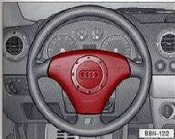
**L'airbag frontal côté conducteur** est situé dans la plaque de rembourrage du volant de direction. L'emplacement de montage est signalé par le monogramme « AIRBAG ».
