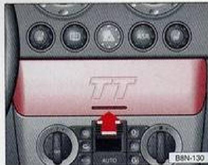
L'autoradio est dissimulé derrière un cache. Appuyez brièvement sur le cache pour l'ouvrir.
