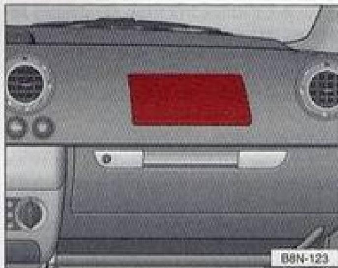
**L'airbag frontal côté passager avant** est logé dans le tableau de bord, au-dessus de la boîte à gants. L'emplacement de montage est signalé par le monogramme « AIRBAG ».
