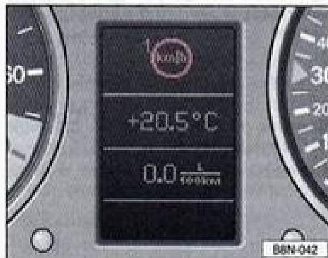
Le dispositif d'alerte de dépassement de la vitesse permet de mémoriser une vitesse que l'on ne veut pas dépasser. Dès que la vitesse du véhicule dépasse d'environ 10 km/h la vitesse programmée, un signal d'alerte retentit. Le symbole d'alerte « km/h » apparaît simultanément sur le visuel.
