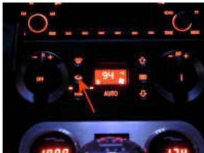
Inmediatamente el display del clima, nos muestra un numero parecido a 13.6 este es en voltios el voltaje de la bateria. Evidentemente no tiene porque ser 13.6, cada coche y circunstancia (motor apagado, encendido etc) muestra un voltaje.
