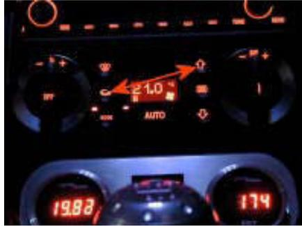
La eleccion de los canales la hacemos con la ruleta de la temperatura, hacia la derecha +canal y para la izquierda -canal de uno en uno.
