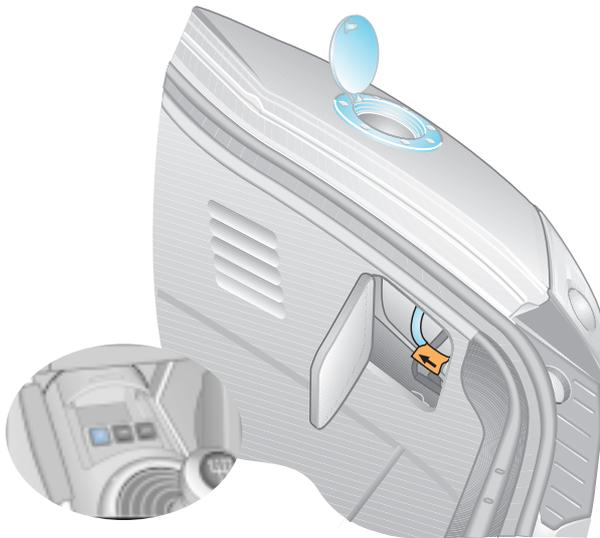
Die Tankklappe besteht aus Aluminium. Sie öffnet nur elektrisch über einen Schalter in der Mittelkonsole.
