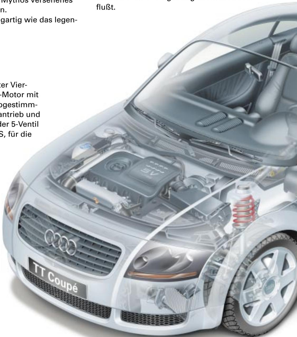
Die Basisversion ist mit 16 Zoll Rädern der Reifendimension 205/55 R 16 ausgestattet. Ein 17 Zoll-Fahrwerk wird serienmäßig für den Quattro und optional für alle anderen Motorisierungen angeboten.
